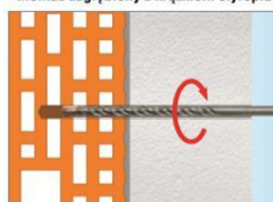
• Montaż zagłębiony z krążkiem styropianowym
